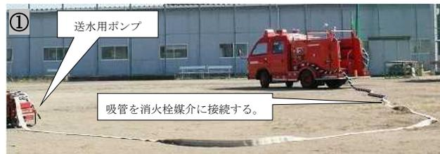
写真5：ホース・吸管接続例
