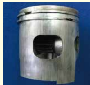
オイル不良 ピストンの異常磨耗 (全周に縦キズあり)
