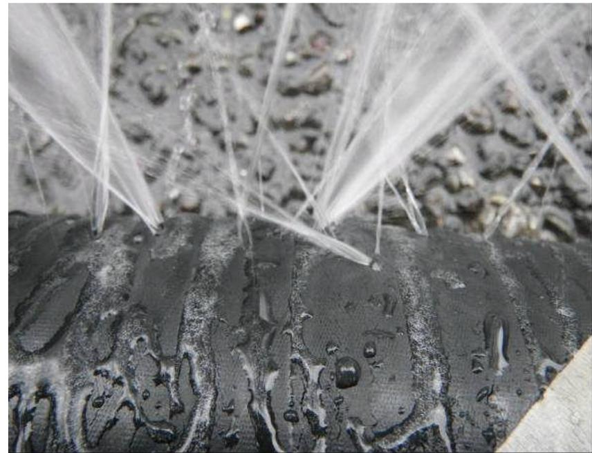
写真4 耐圧／破壊試験時の状況
