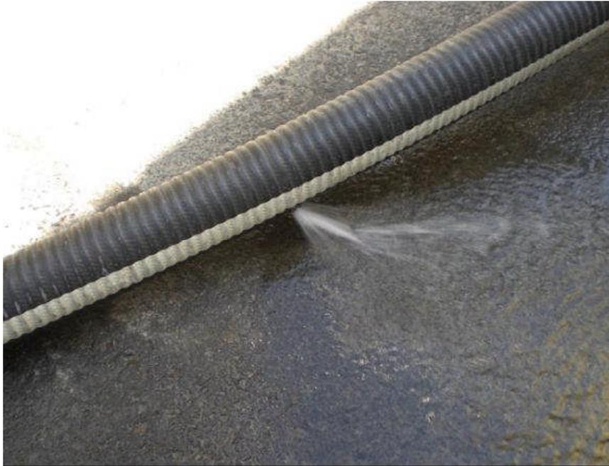
写真3 耐圧／破壊試験時の状況
