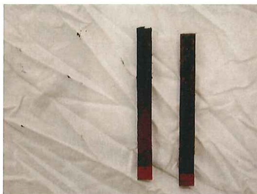
写真 1 3. 耐熱試験後の試験片 (B 法) (左 ; 難燃性, 右 ; 普通樹脂)
