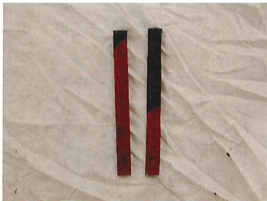
写真 1 5 . 試験後の試験片 (C 法) (左 ; 難燃性, 右 : 普通樹脂)
