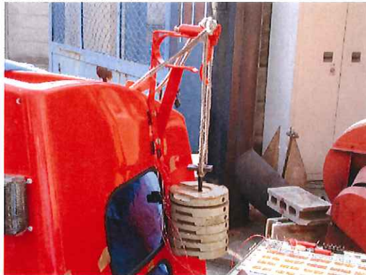
写真 2 4. 吸水管ブラケット部試験 (垂直方向)
