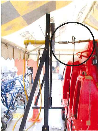
写真 2 1. 梯子ブラケット部試験（水平方向）
