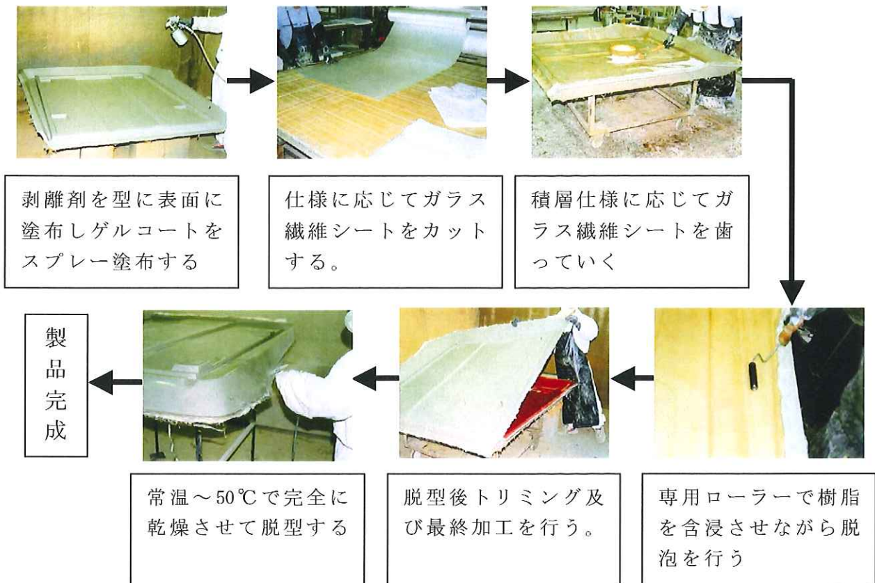
図6. ハンドレイアップ法製造工程 (参考)
