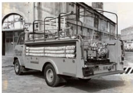
小型動力ポンプ付積載車（棒吸管）
